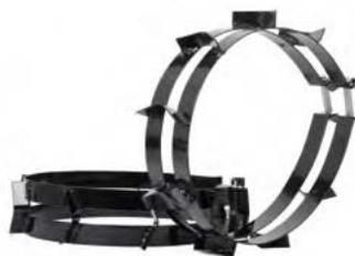
Para colocar sobre os pneus e utilizar em terreno lamacento.
