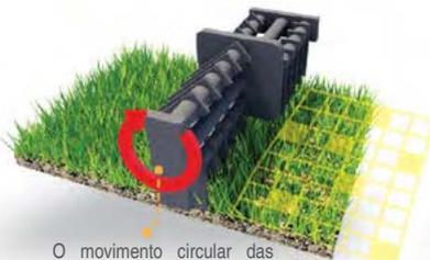
O movimento circular das lâminas removendo o material orgânico decomposto.
