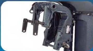
A morsa de fixação e ajuste de inclinação de 4 níveis oferecem estabilidade e flexibilidade para uma navegação eficiente
