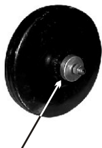
Fig. 16 Lubrificação do cubo e eixo da roda de ferro da enxada rotativa.
